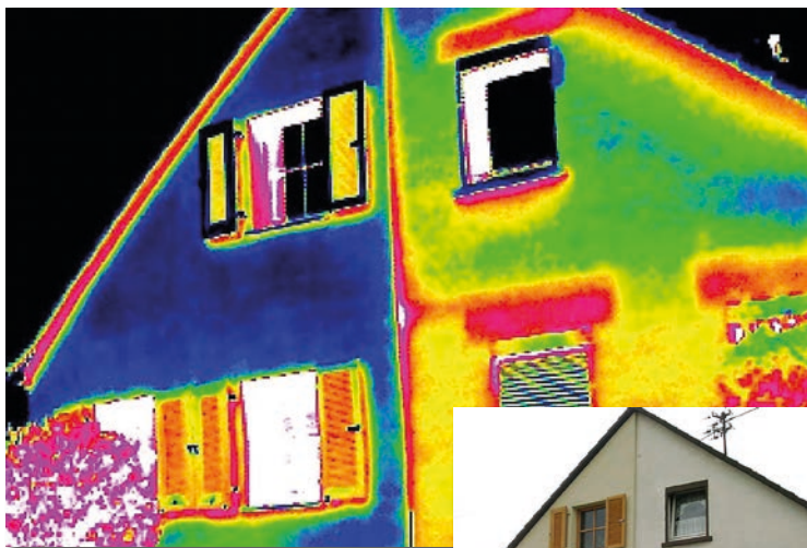
Beispiel: Die linke Gebäudehälfte wurde bereits saniert.
